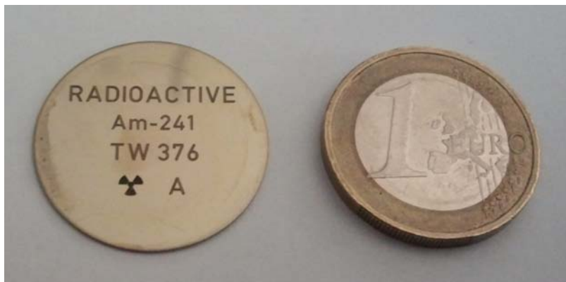
figura 6.11. Fotografía de la fuente de partículas alpha junto a una moneda para apreciar su tamaño
