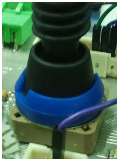
figura 6.13. Sistema de fijación de la fuente radioactiva al zócalo
