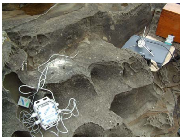
Fig. 2.21 Dispositiu instrumental del seguiment de les variacions de microtopografia horàries a Hayley Point, Marengo.
