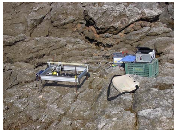
Fig. 2.3 Dispositiu de l'escàner làser i el seus components. A l'esquerra de la imatge, el marc sobre el qual es desplaça l'emissor-sensor làser i el sistema de potes que n'assegura la relocalització. A la dreta de la imatge, l'ordinador, la caixa de motors i les bateries.
