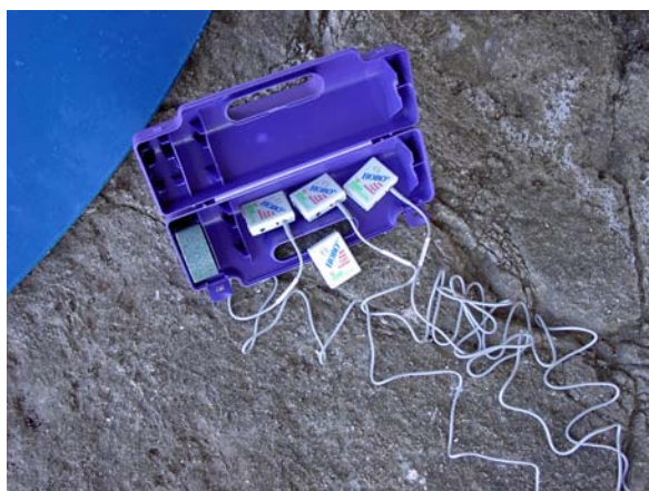
Fig. 2.12 Dispositiu de seguiment horari dels canvis de microtopografia i variables ambientals a s'Alavern. A la fotografia superior, s'hi pot observar el micròmetre de dial mòbil sobre la superfície estudiada i el protector d'insolació directa dels termòmetres i registre d'humitat relativa. La fotografia inferior és un detall del dispositiu de control de variables ambientals. D'esquerra a dreta el sensor per a la mesura de la temperatura a la superfície de la roca, a -1,5 cm i a -3,5 cm. El dispositiu sense sensor extern registra la temperatura i humitat ambiental i la insolació.
