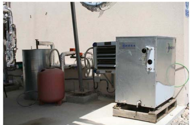
Figura 7.49: a) Equipos de medida. b) Algunos elementos del banco de ensayos (máquina enfriadora, aerotermo, depósito de inercia, vaso de expansión, bomba, válvulas 3V, ...)
