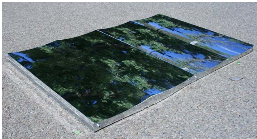
Figura 7.30: Dos de los paneles reflectores (4 parábolas) que forman la superficie reflectora del CCStaR V1
