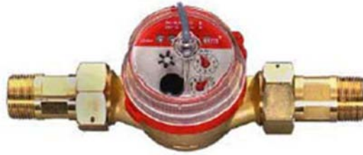
Figura 7.48: Caudalímetro utilizado en el banco de ensayos para CCStAR V1
