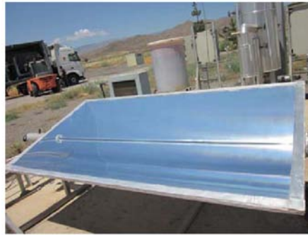
Figura 1.4: Concentrador cilindro-parabólico de pequeñas dimensiones CAPSOL-2. Plataforma Solar de Almería (Fernández et al., 2010b)
