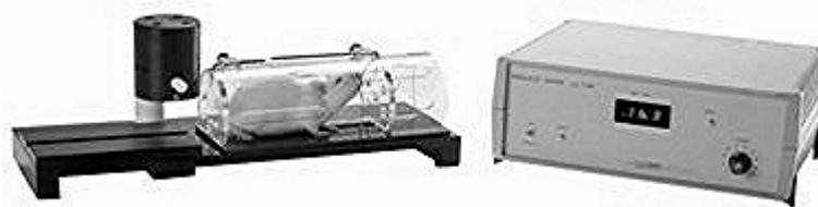
**Fig. 3.2** Analgesímetro utilizado en los experimentos
