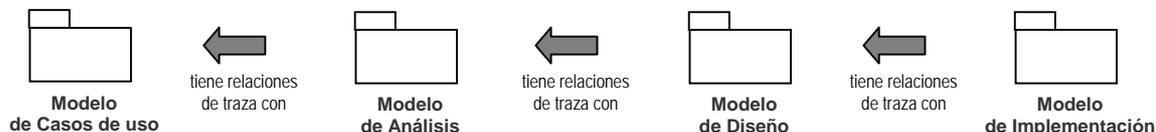
Figura 8. Relación entre modelos del sistema
