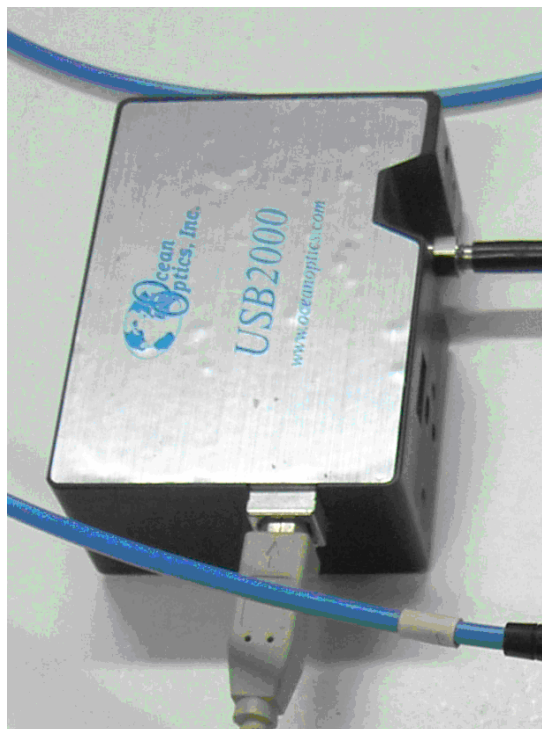
Figura 1.16.- Sistema de detección espectrofotométrica constituido por un espectrofotómetro CCD (USB 2000, Ocean Optics).
