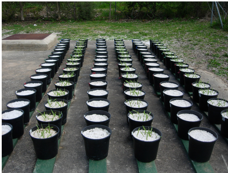
Figura 3.6. Experiència realitzada en contenidors de polietilè en la què es compara el comportament del sòl i del cultiu de tres tipologies de terra regades amb diferents tipus d'aigua.
