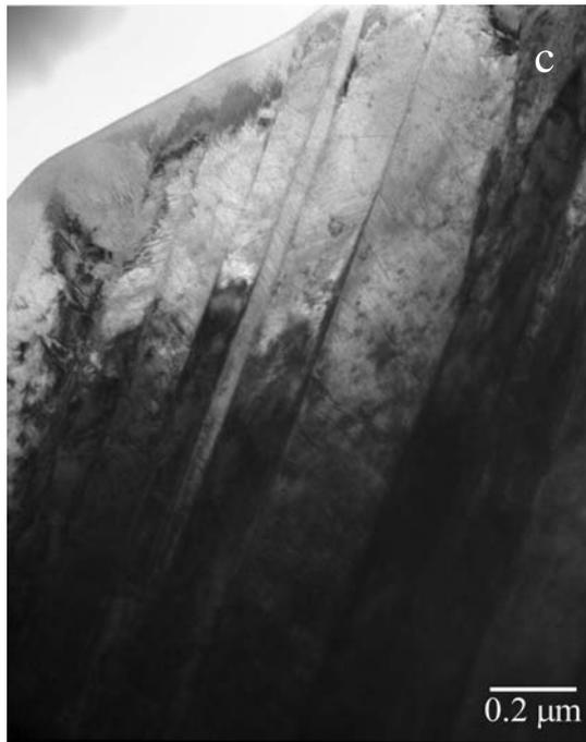
**Figura 18.** Fotografías de microscopía de transmisión de una muestra de Ni<sub>50</sub>Ti<sub>32</sub>Hf<sub>18</sub> después de un tratamiento de 10 minutos a 500 °C. Tanto (a) como (b) muestran una imagen de los cristales de pequeño tamaño que se pueden encontrar en la muestra, mientras que (c) es la imagen de una zona característica con granos grandes.
