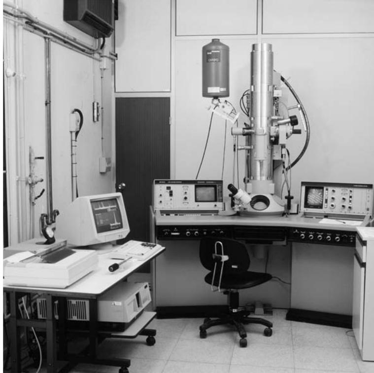
**Figura 12.** Fotografía del microscopio electrónico de transmisión Hitachi H600.
