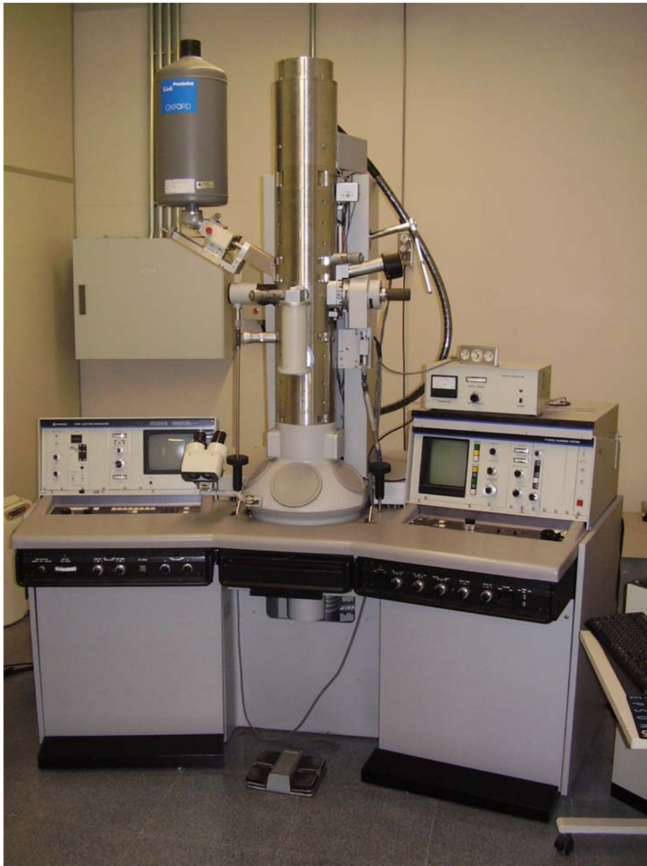
Fig. 2. 7 Imatge del microscopi electrònic de transmissió Hitachi H-600 dels Serveis Científic-tècnics de la UIB.
