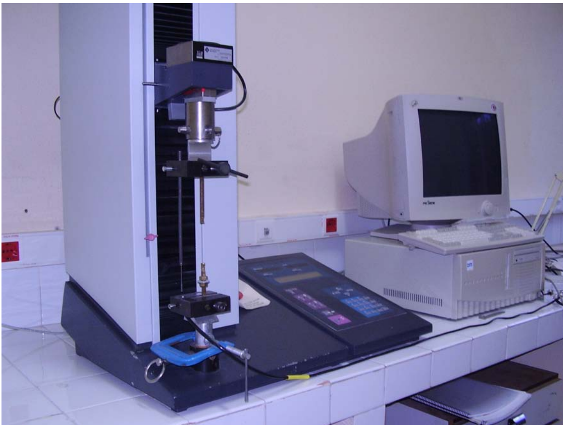
Fig. 2. 2 Imatge de la màquina d'assaigs Adamel-Lomarghy DY30
