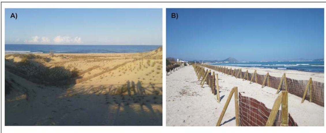
Figura 196: Exemples sobre la mala disposició de trampes d'interferència sedimentària en sistemes litorals arenosos. L'imatge A mostra l'escassa eficiència mostrada per trampes disposades a la cara de sobrevent de la primera duna en el sistema de Cala Mesquida (Mallorca), mentre que l'imatge B exemplifica l'escassa eficiència de trampes diposades responent a l'orientació de la línia de costa, sense tenir en compte els vents predominants incidents; exemple de la platja de Can Picafort (Mallorca).
