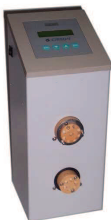
Figura 3.4 Módulo de válvulas mixto. Válvula de selección de 8 puertos en su parte superior. Válvula de inyección de 6 puertos en su parte inferior.
