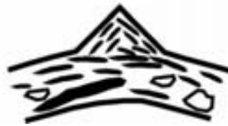
Figura IV-17: Ordenación de las inclusiones de forma triangular asociadas al pellizado
