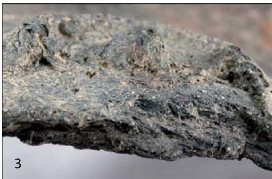
Fractura laminar que se asocia al pegado por arrastrado de la banda
