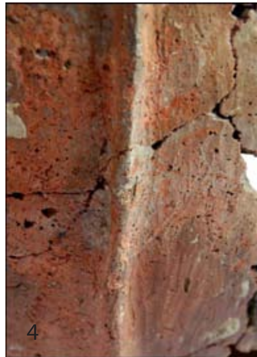
Hendiduras relacionadas con la confección y ensamblaje por presionado Bandas heterogéneas formadas durante el bruñido
