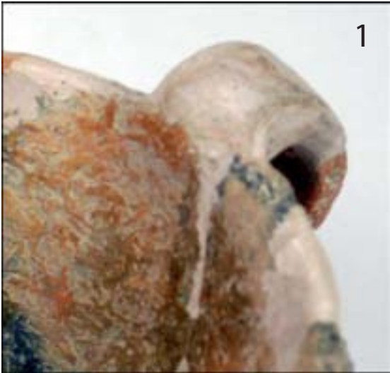
Hendiduras asociadas al ensamblaje por presionado
