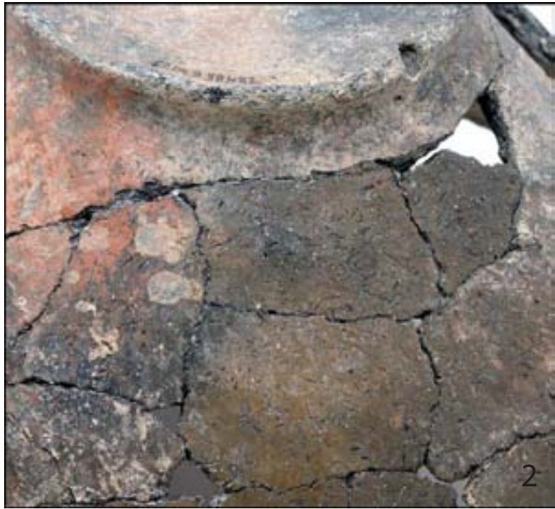
Patrón de fractura relacionado con el urdido
