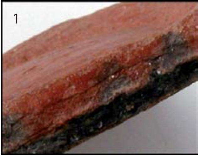
Rebabas asociadas al ensamblaje por arrastrado
