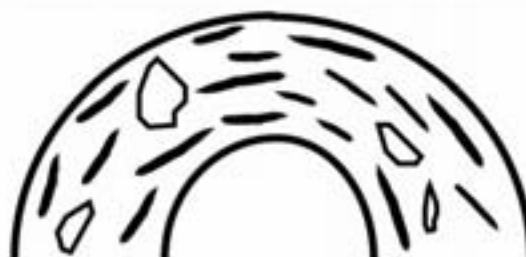
Figura IV-18: Ordenación de las inclusiones de forma curva asociadas al doblado
