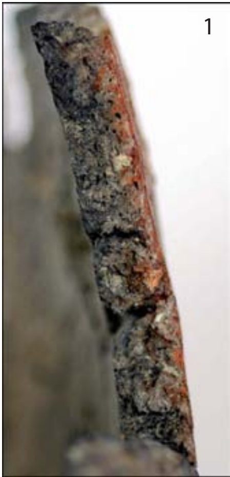
Grietas y fracturas transversales que muestran la colocación de los colombinos en el cuerpo
