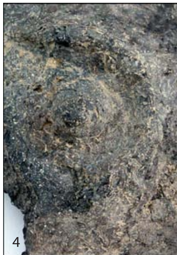
Fractura laminar que se asocia al pegado por arrastrado de la banda
