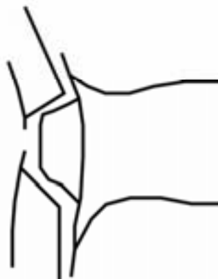
Figura IV-116: Fracturas laminares en el cuerpo asociadas a la inserción completa del elemento secundario ensamblado por arrastrado
