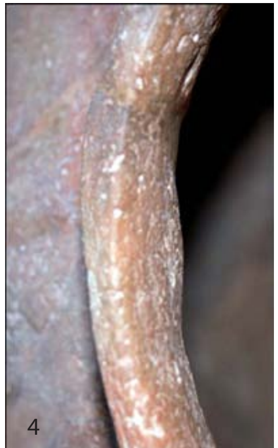
4 Hendiduras que indican el doblado de la boca
