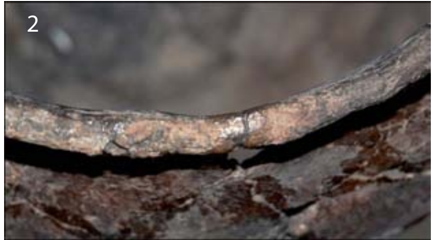
Hendiduras que indican el doblado de la boca
