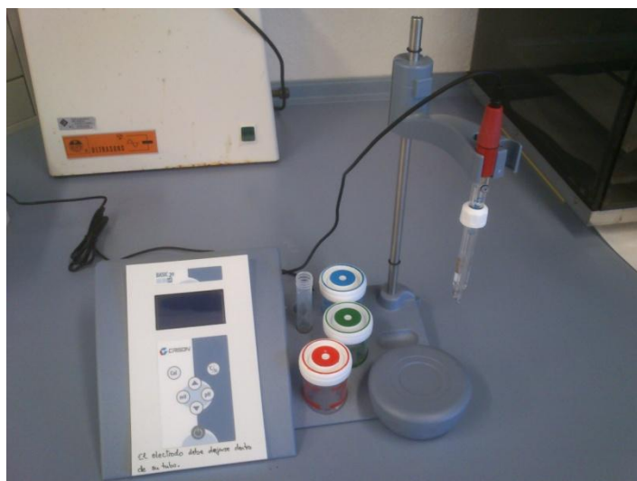
Fig 9. Potenciómetro Crison 52-61 con electrodo combinado de platino utilizado para medir el potencial redox urinario.
