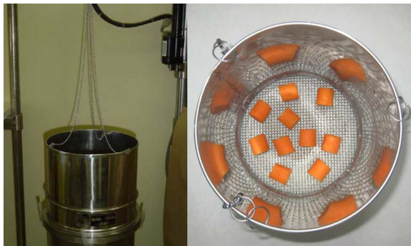
Figura. 3.6. Vista lateral y superior de la canastilla portamuestras del secadero de vegetales a escala de laboratorio.
