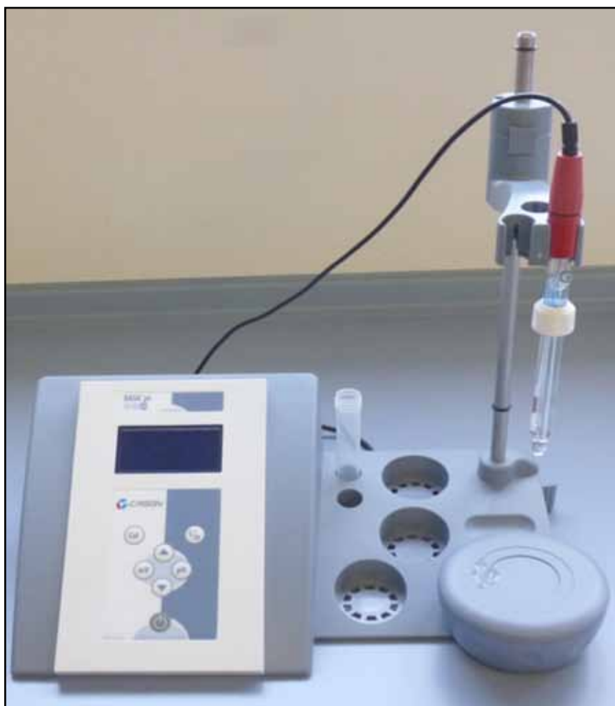
Figura 8. Potenciómetro de Crison y electrodo combinado de platino/calomelanos.
