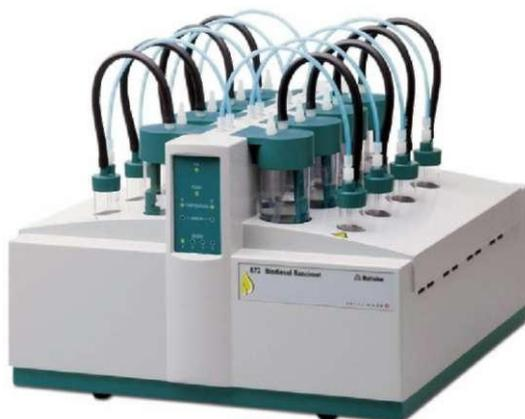
**Figura 3.14.** Equipo para determinar la estabilidad oxidativa. Modelo Rancimat 743
