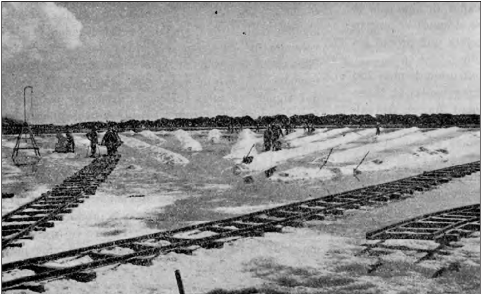
Fig. 4. Transporte de la sal. La sal se amontona en las plazas construidas al efecto junto a los cristalizadores ( salers ) o se almacena en los depósitos situados junto al embarcadero. El transporte se efectúa por medio de vagonetas.
