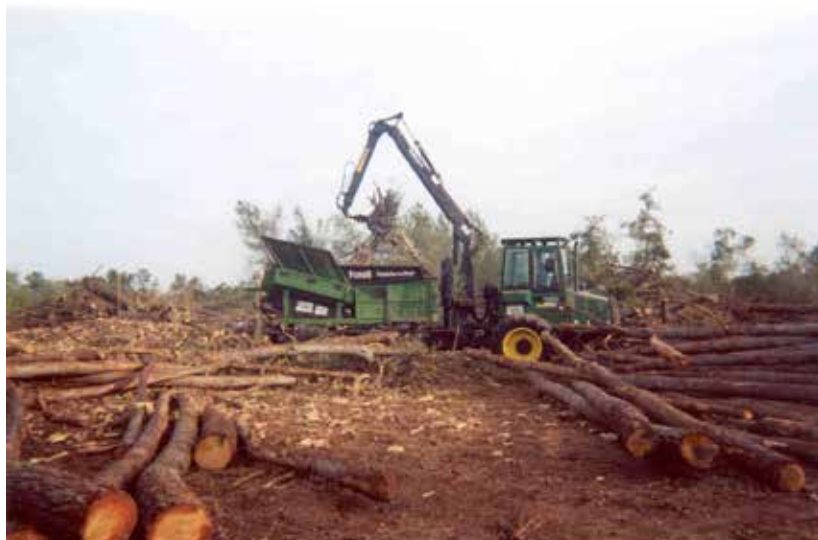
Figura 25. Treballs de processament de la biomassa forestal mitjançant maquinària forestal específica (trituratora Forus).
