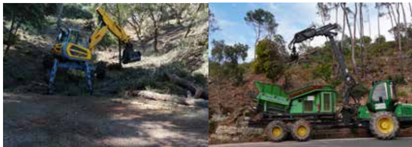
Figura 65. Retroaranya (a) i trituradora Forus (b), màquines emprades per triturar les restes vegetals.
