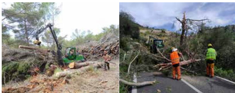
Figura 72. Maquinària forestal específica, autocarregador (esquerra) i treballadors forestals obrint vials (dreta).
