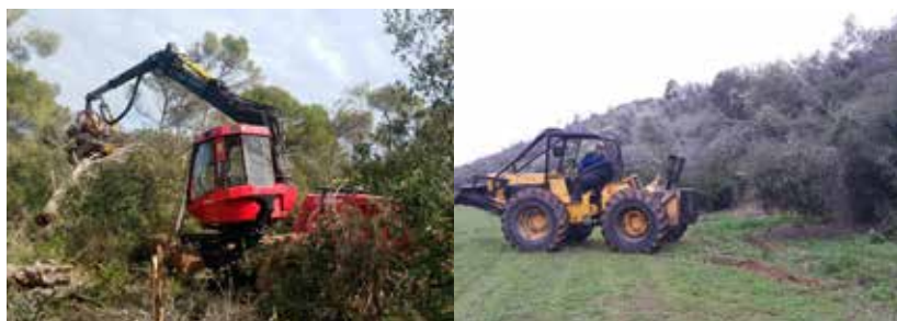
Figura 36. Maquinària forestal específica utilitzada: processadora (esquerra) i skidder (dreta).
