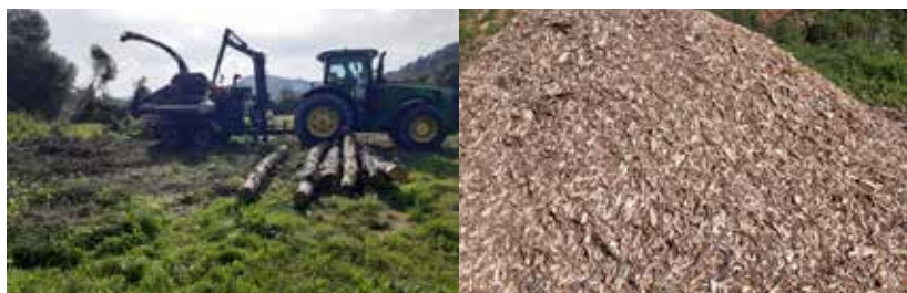
Figura 37. Aprofitament de fusta per a serradora (esquerra) i trituració de la biomassa per a producció d'estella (dreta).
