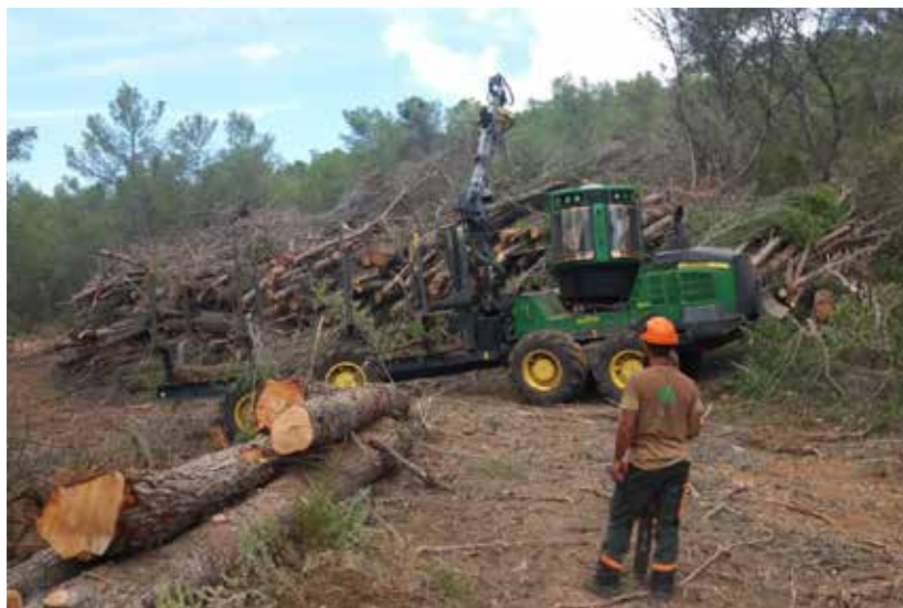
Figura 50. Treballs forestals amb autocarregador apilant la biomassa extreta.
