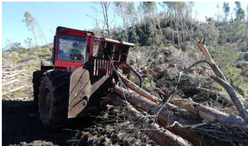
Figura 64. Skidder arrossegant troncs danyats, prèviament talats.
