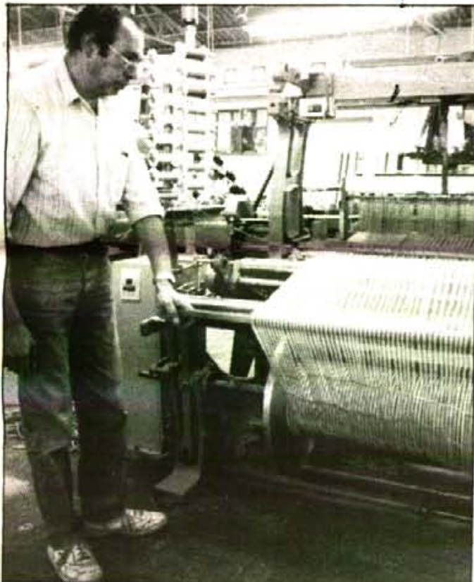
A principis dels 80 es canviaren 120 telessos antics per 20 de moderns que fan teles de 160 cm. d'amplària
