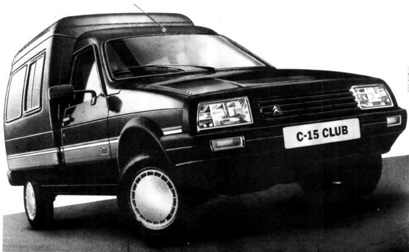
EQUIPAMIENTO C-15 CLUB: 70 caballos de potencia en gasolina • 60 caballos de potencia en Diesel • Hasta 765 Kg. de capacidad de carga • Hasta 1.764 cc • Pre-equipado de radio • Tapizados y guarnecidos completos hasta la zona de pasajeros • Reloj analógico • Embellecedores de ruedas tipo "full-cover" • Reposacabezas delantero • Nuevo anagrama en calandra y volante • Iluminación adicional en zona de carga • Cinco velocidades.
