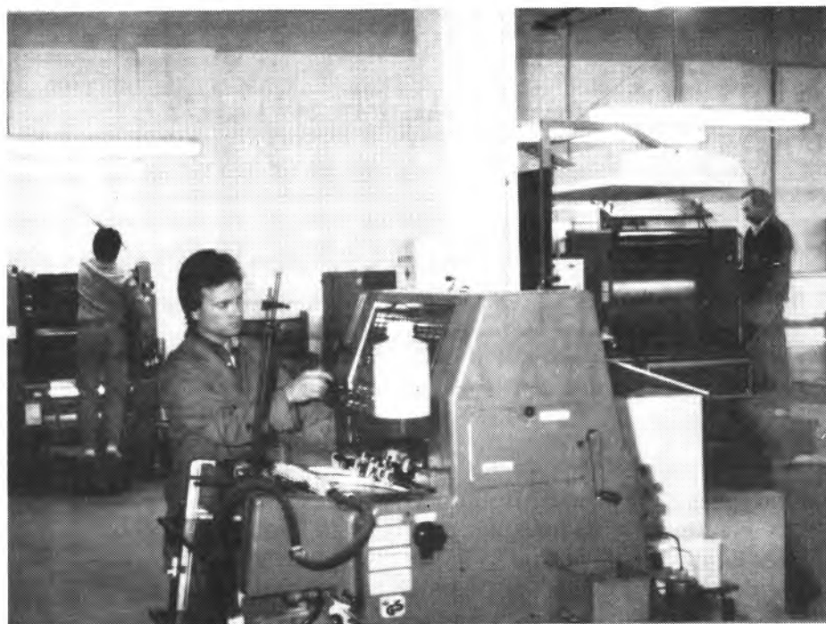
La flamante impresora de fabricación alemana, dispone de dos cuerpos y una velocidad de tirada de 12.000 ejemplares hora (a dos tintas) del tamaño 45x65 cm.
