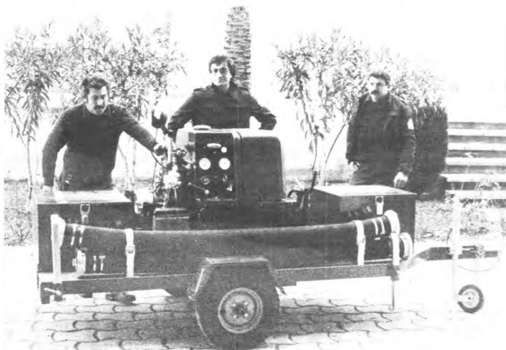
He aquí la moto-bomba que recibió el Parque de Bomberos el pasado jueves. Es de fabricación alemana (Magirus-Dentz) y tiene doble utilidad, ya que tanto sirve para achicar como para lanzar agua. Su capacidad de achique es de 180.000 litros hora.
