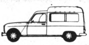
Renault 4 F6 Renault 4 F6 Acristalada Cilindrada 1.108 cm 3 Potencia máxima, 38 CV DIN a 4.500 r.p.m.
