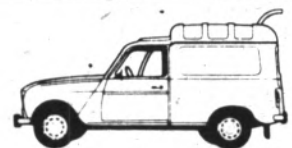
Renault 4 Furgoneta Cilindrada 1.108 cm 3 Potencia máxima, 38 CV DIN a 4.500 r.p.m.
