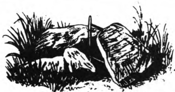
Llosa mallorquina: 1.- Llosa o tiba; 2.- puntal o batalla; 3.- palanca o clavilla; 4.- costella; 5.- menja y 6.- bancal, tibal o capceler.
