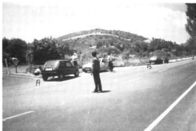
El vehículo A, quería girar hacia Porto Cristo, el vehículo B, quedó en este lugar, tuvo que realizar una frenada de 78 metros
