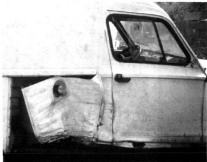
Estado en que quedó el depósito de la gasolina
