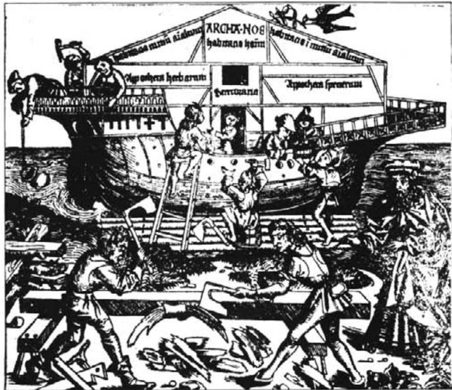
Il·lustració de "La Crónica de Nuremberg" que representa la construcció d'una carraca. Les carracs tenien menys eslora i més manga que les carabelas i contaban amb major desplaçament.
