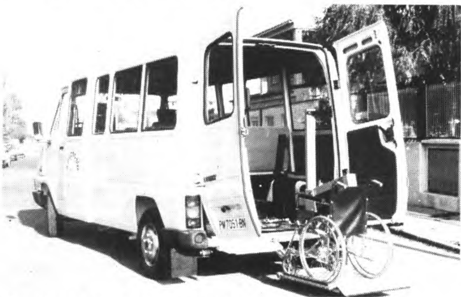
D'aquesta manera una cadira de rodes pot entrar al minibus
