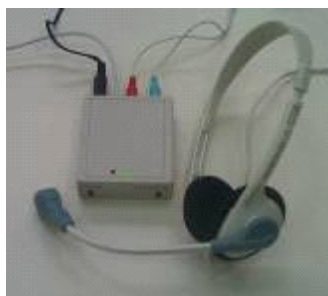
Figura 15. Sistema emulador de ratón con reconocimiento de voz
