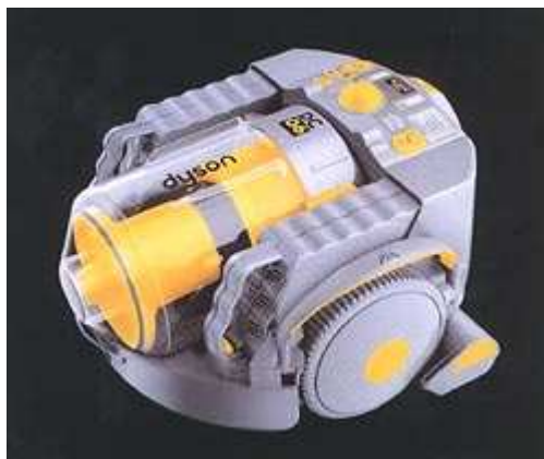
Figura 50.- Aspirador automático (robotizada) que recorre las estancias recogiendo todo lo que ha caído en el suelo.
