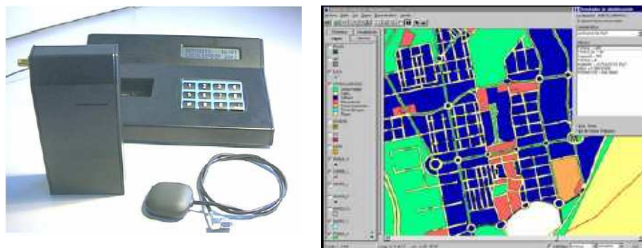
Fig. 40.- Localizador de personas basado en tecnología GPS/GSM
