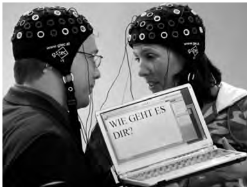
Figura 2 | Sistema BCI basat en EEG amb elèctrodes segons en el sistema 10-20 per a la comunicació entre usuaris
