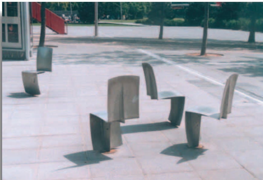
Área estancial con asientos de difícil detección y aristas vivas.
