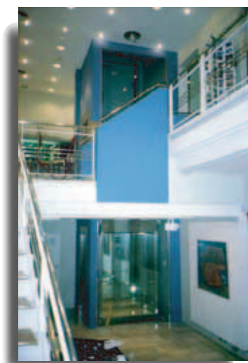
Fig. 11 y 12. Una correcta utilización del ascensor permite resolver situaciones complejas. Este local con escasa superficie a nivel de calle se convierte en accesible mediante un ascensor de doble puerta que permite acceder al semisótano y al attillo.
