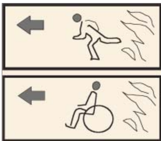
Figura 4. Ejemplo de señalización de ruta de evacuación.
