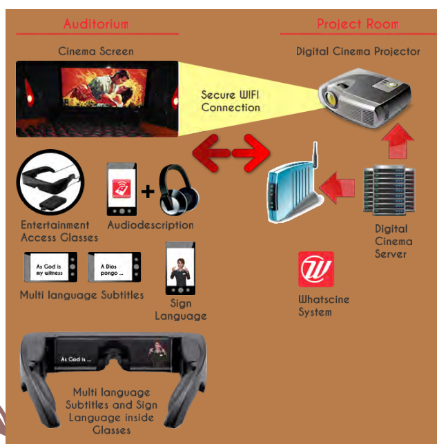
Imagen 1. Esquema de funcionamiento del sistema Whatscine en una sala de cine comercial
