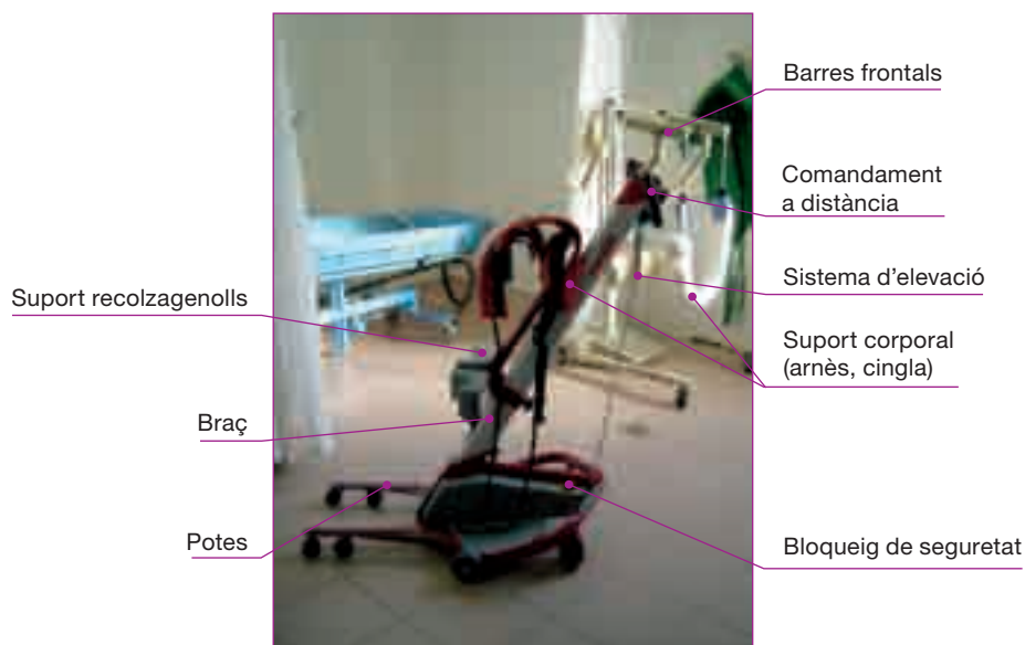
24. Parts d'una grua de bipedestació.
