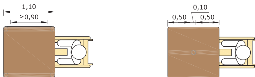
Imágenes 115 y 116. Criterios de diseño en mesas de una y cuatro patas.
