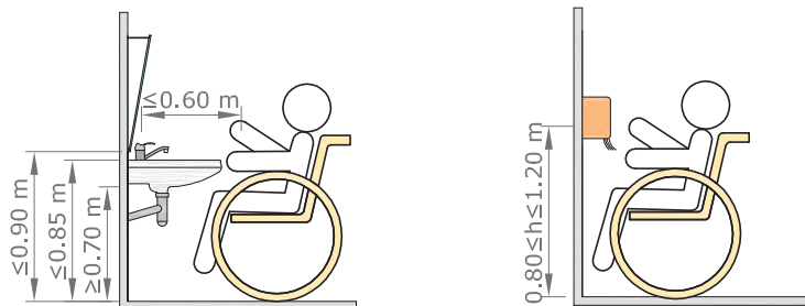
Imágenes 187 y 188. Detalle de colocación de lavabo y accesorios en un aseo.
