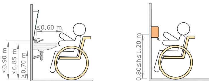
Imágenes 53 y 54. Detalle de colocación de lavabo y accesorios en un aseo.
