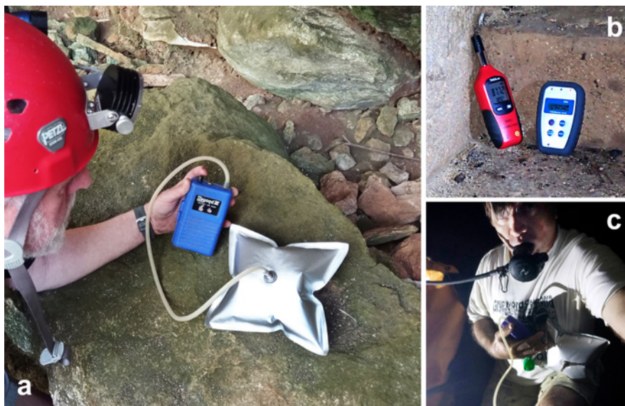
Figura 5: Equipament utilitzat pels mostrejos d'aire i les mesures de camp. a) Bosses tipus Ritter i bomba-compressor per omplir-les. b) Termòmetre digital i mesurador de la firma \text{CO}_2 meter, amb un rang de mesura fins a 50.000 ppm. c) Els mostrejos amb concentracions de \text{CO}_2 superiors a 50.000 ppm han fet necessari l'ús d'equips autònoms de respiració, fins i tot fora de l'aigua.
