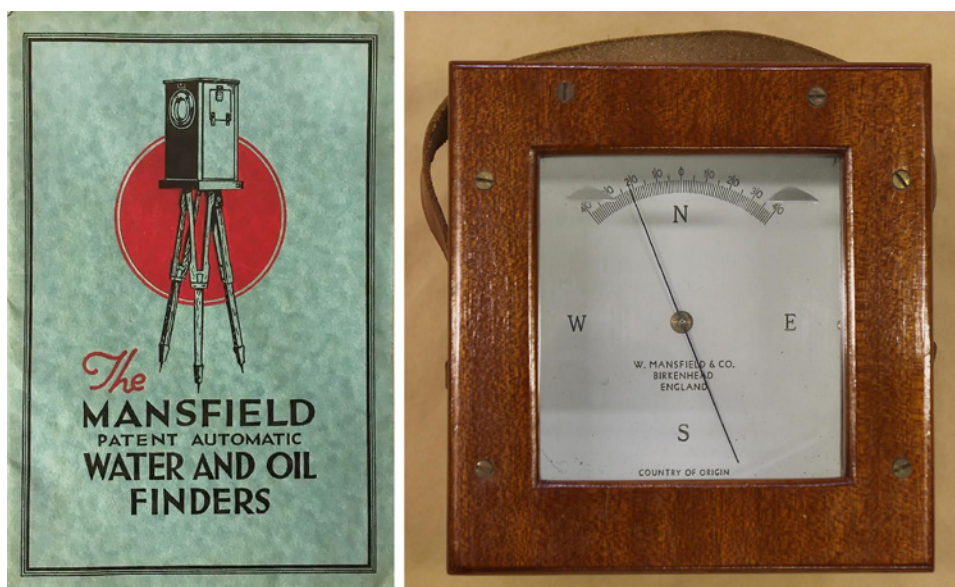
Figura 6: Manual d'instruccions i vista zenital d'un "descubridor de Mansfield". A través del visor s'hi observa l'agulla magnètica.
