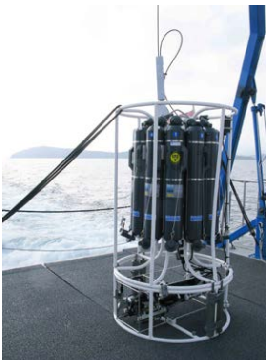
Figura 2. Exemple de dispositiu CTD utilitzat en campanyes oceanogràfiques per mesurar paràmetres de temperatura, salinitat i profunditat, entre altres variables. FONT: Miquel Gomila.
