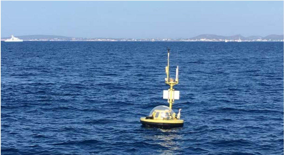
Figura 3. Boia oceanogràfica del SOCIB a la badia de Palma utilitzada per mesurar les variables oceanogràfiques de superfície (~ 5 m de profunditat). FONT: Natalia Barrientos.
