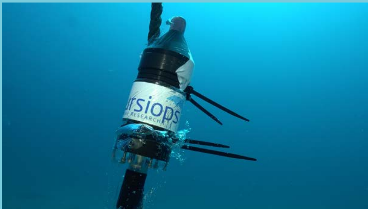
Imatge d'un hidròfon submergit, un aparell emprat per mesurar els sons submarins. FONT: Rubén Casas.
