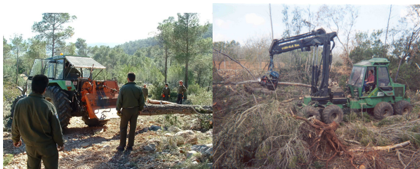
Figura 24. Extracció de tronc semi suspès amb tractor (esquerra) i retirada d'arbres abatuts mitjançant maquinària forestal específica –processadora– (dreta).
