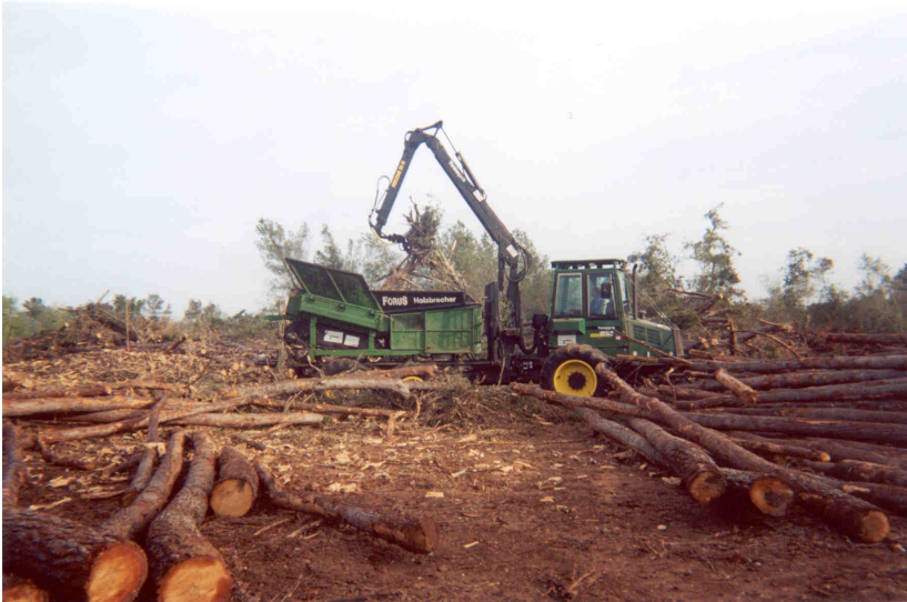
Figura 25. Treballs de processament de la biomassa forestal mitjançant maquinària forestal específica (tritadora Forus)
