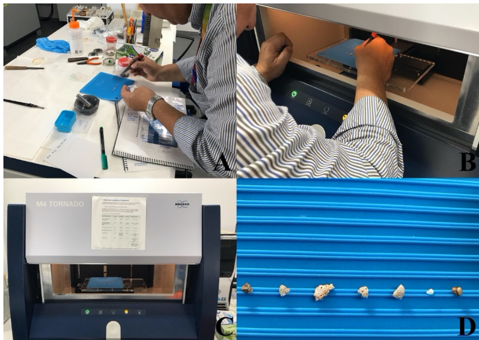
Fig. 2. Selección de las muestras arqueológicas y modernas tomadas y su procesado con un espectro FRX. Fig.2. Selection of archeological and modern samples taken and their processing with an XRF spectrum.
