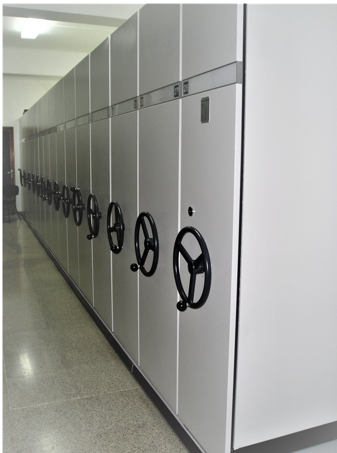
Fig. 1. Armarios compactos con railes en la SHNB.
