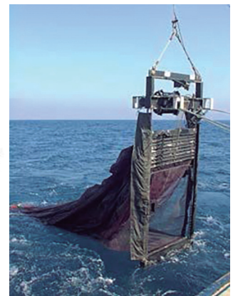
Figura 5. Xarxes Multinet (esquerra) i MOCNESS (dreta) per a mostreig planctònic estratificat emprades al programa TUNIBAL (Font: www.hydrobios.de ).
