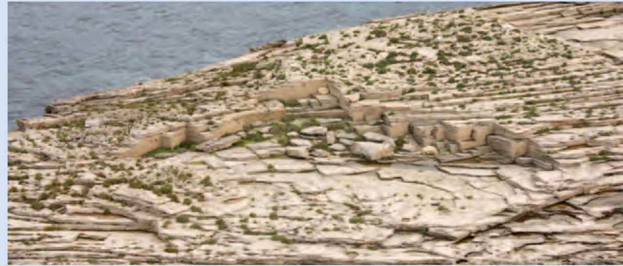
A moltes petites illes és visible el rastre de la tasca dels antics trencadors de marès, que tallaven, a cops d'escoda, peces de roca arenosa per a la construcció. Aquests artesans aprofitaven les discontinuïtats entre els estrats per obtenir les seves peces. A la imatge, pedreres abandonades a l'illa Pelada.
