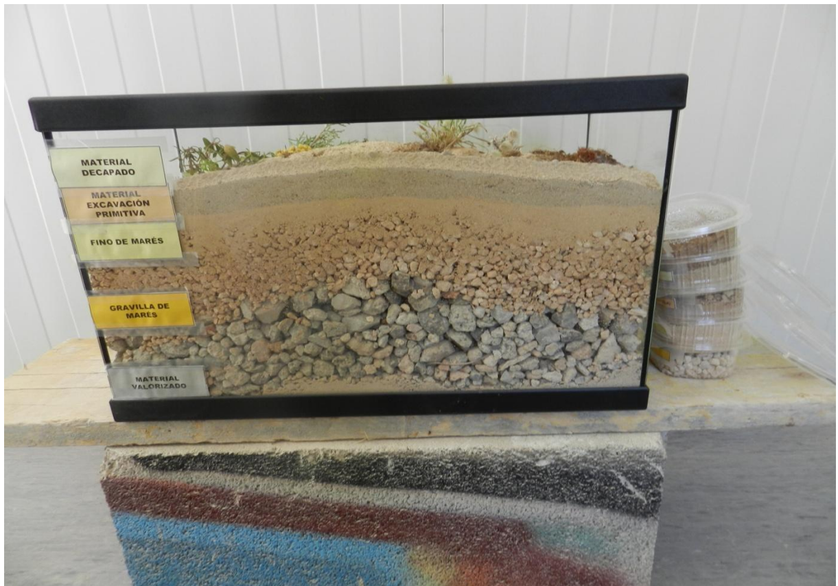
Fig. 19. Maqueta descriptiva model de disposició de materials en perfil edàfic (maqueta realitzada per Sergio Mulet. TRAGSA)
