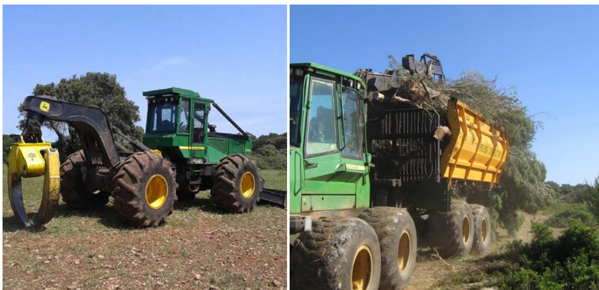
Foto 7: Skidder forestal per a desembosc amb pinça per a càrrega semisuspesa.
