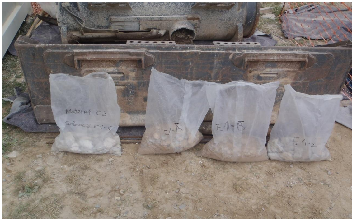
Fig. 13. Mostres RCD fragmentats per a la seva caracterització a laboratori .
