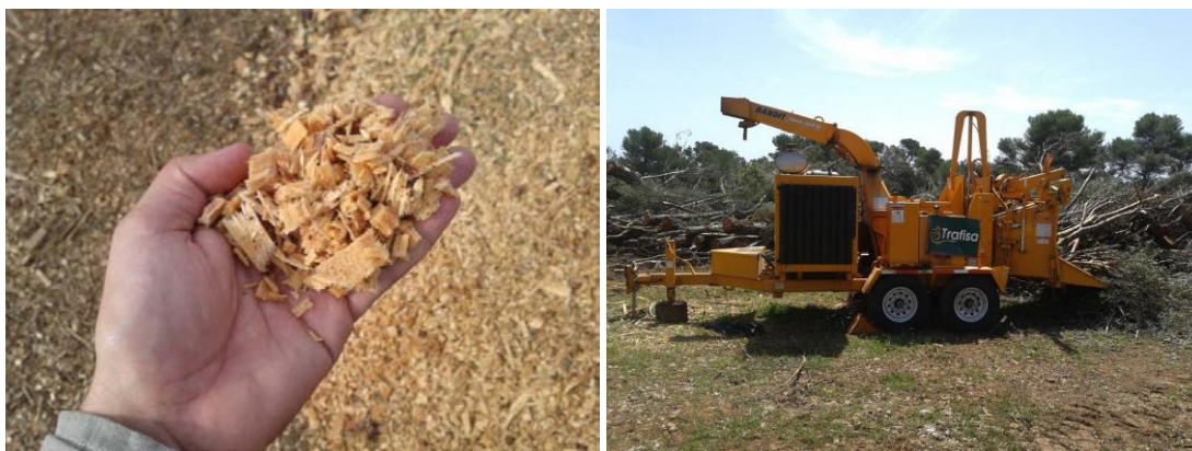
Foto 6: Detall de l'estella obtinguda i estelladora de discs utilitzada
