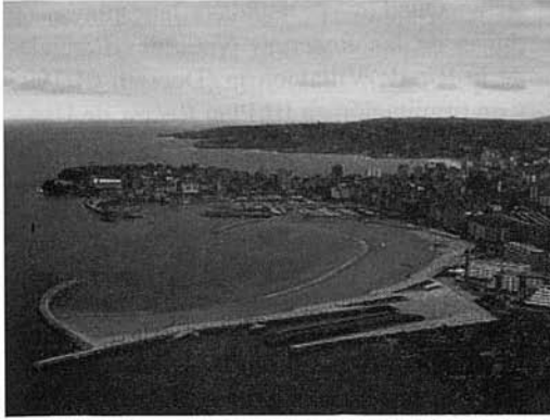
Fig. 3. Playa arenosa de Poniente en la ciudad de Gijón (Asturias central), creada artificialmente. Fig. 3. Western sand beach in the city of Gijón (central Asturias), artificially generated.
