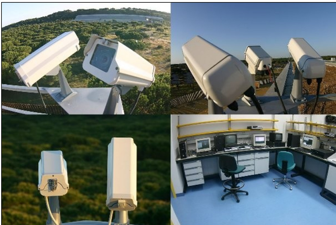
Figura 2: Imágenes de la sala de control y de algunas de las cámaras CCD de vídeo de alta sensibilidad operadas por la UHU desde el Parque Natural de Doñana para llevar a cabo la detección de meteoros en la atmósfera terrestre.
