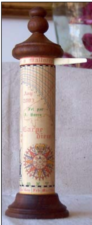
Figura 20: El rellotge de pastor és un rellotge portàtil de viatge que suposadament usaven els pastors dels Pirineus. N'hi havia de senzills, gravats directament damunt la fusta, o més elaborats i decorats segons qui era el destinatari. Els rellotges de pastor són rellotges d'altura, l'hora es determina segons l'altura del Sol.
