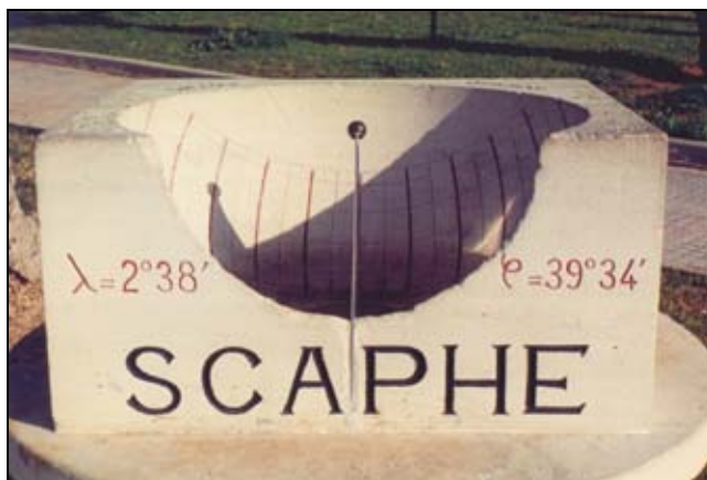
Figura 4: Els babilònics inventaren el rellotge de sol hemisfèric (hemiciclum), hemisferi còncav buidat en pedra amb un gnòmon vertical clavat en el centre.
