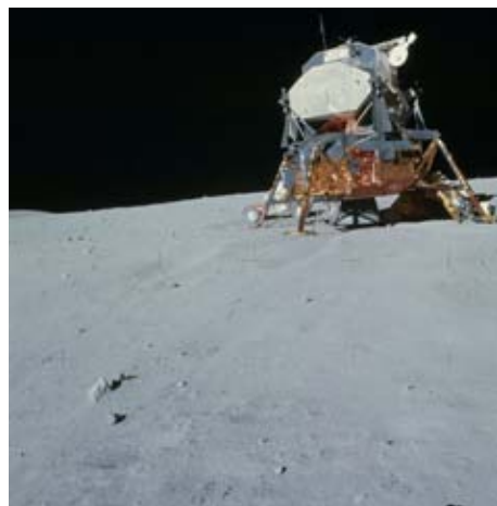
Figura 7: El Módulo Lunar, LM, fue diseñado únicamente para aterrizar en la Luna y ascender desde la superficie lunar hasta el Módulo de Mando, CM. (NASA/Cortesía de nasaimages.org).
