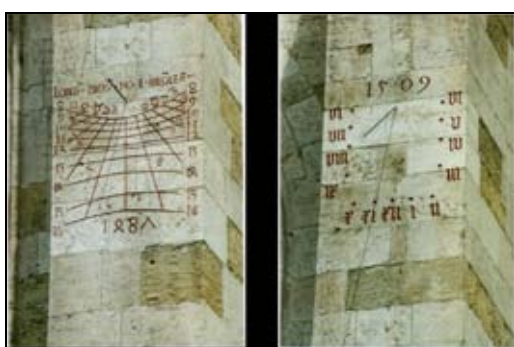
Figura 16: A la ciutat de Regensburg, Alemanya, el rellotge de l'esquerra, amb gnòmon perpendicular a la paret i amb hores planetàries, datat el 1487. A la dreta, 22 anys després, un altre rellotge ara ja amb hores astronòmiques i amb el gnòmon inclinat segons la colatitud del lloc.
