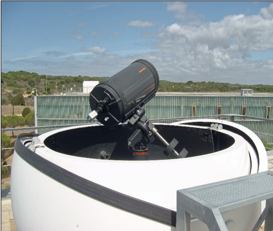
Figura 5: Imagen de uno de los telescopios SC de 14 pulgadas que operan desde el Parque Dunar (Huelva) para detectar impactos de meteoroides contra la superficie de la Luna.
